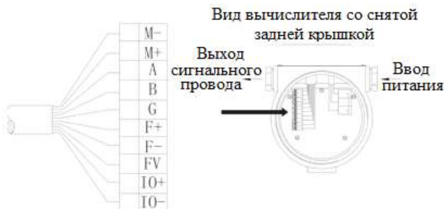
Рисунок 11 Подключение сигнальных выходов вычислителя
