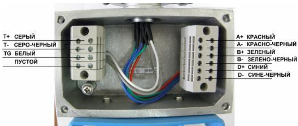
Рисунок 12 - Внешний вид распределительной коробки вычислителя
