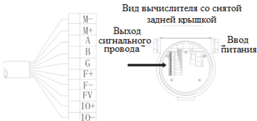
Рисунок 11 Подключение сигнальных выходов вычислителя
