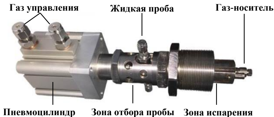
Рисунок 10. Инжектор-испаритель для хроматографа МАГ
