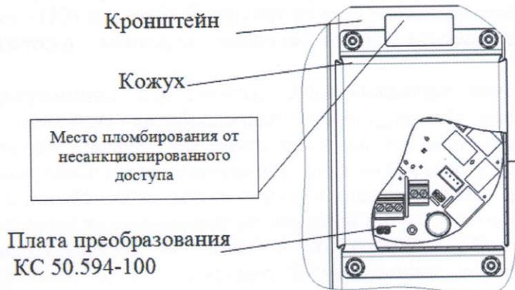
Рисунок 1 - Общий вид анализатора «ГигроСкан-С» KC 50.591-000 и схема пломбировки от несанкционированного доступа
