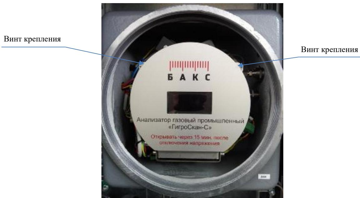
Рис. 24. Откидная панель с дисплеем
