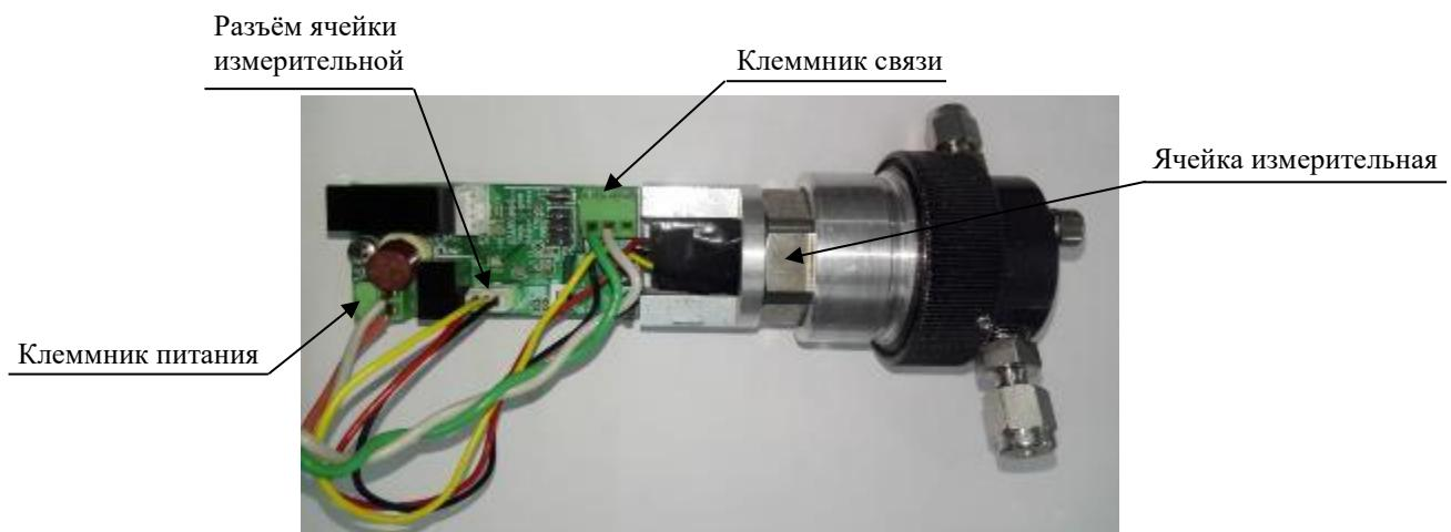
Рис. 28. Плата управления и ячейка измерительная
