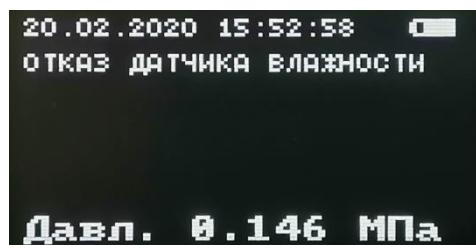
Кратковременным нажатием кнопок «Вверх» или «Вниз» прибор переводится на графическое отображение значений первого (основного) выбранного параметра и обратно:
