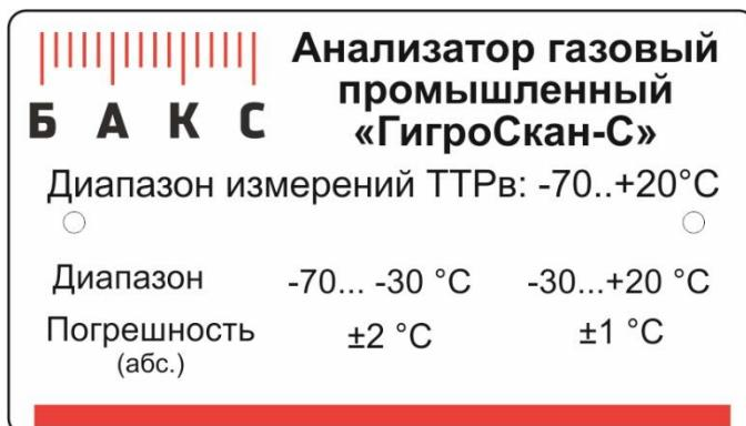
Рис. 15. Табличка с метрологическими характеристиками анализатора
