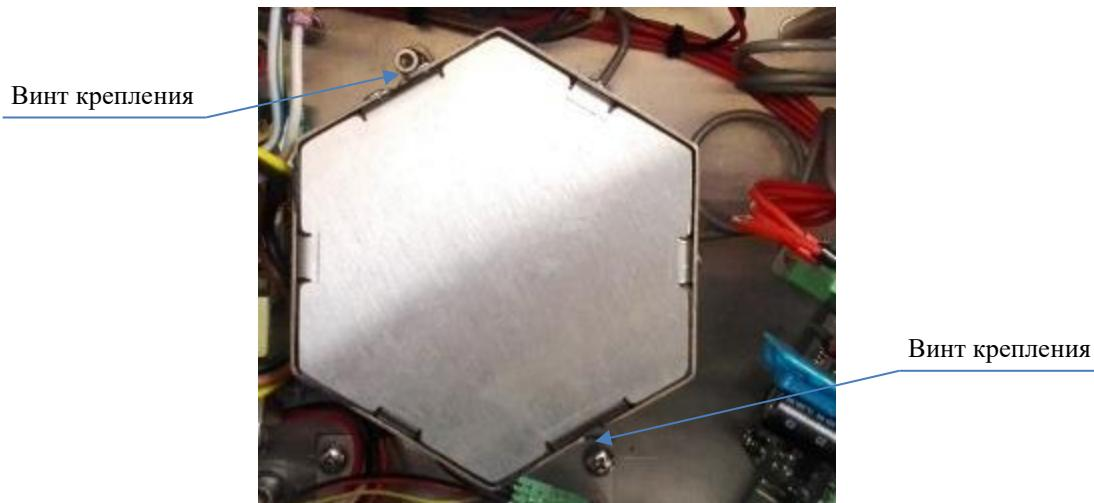
Рис. 25. Кожух термостата
