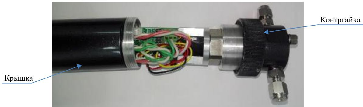
Рис. 27. Корпус анализатора ГигроСкан-T Micro.
