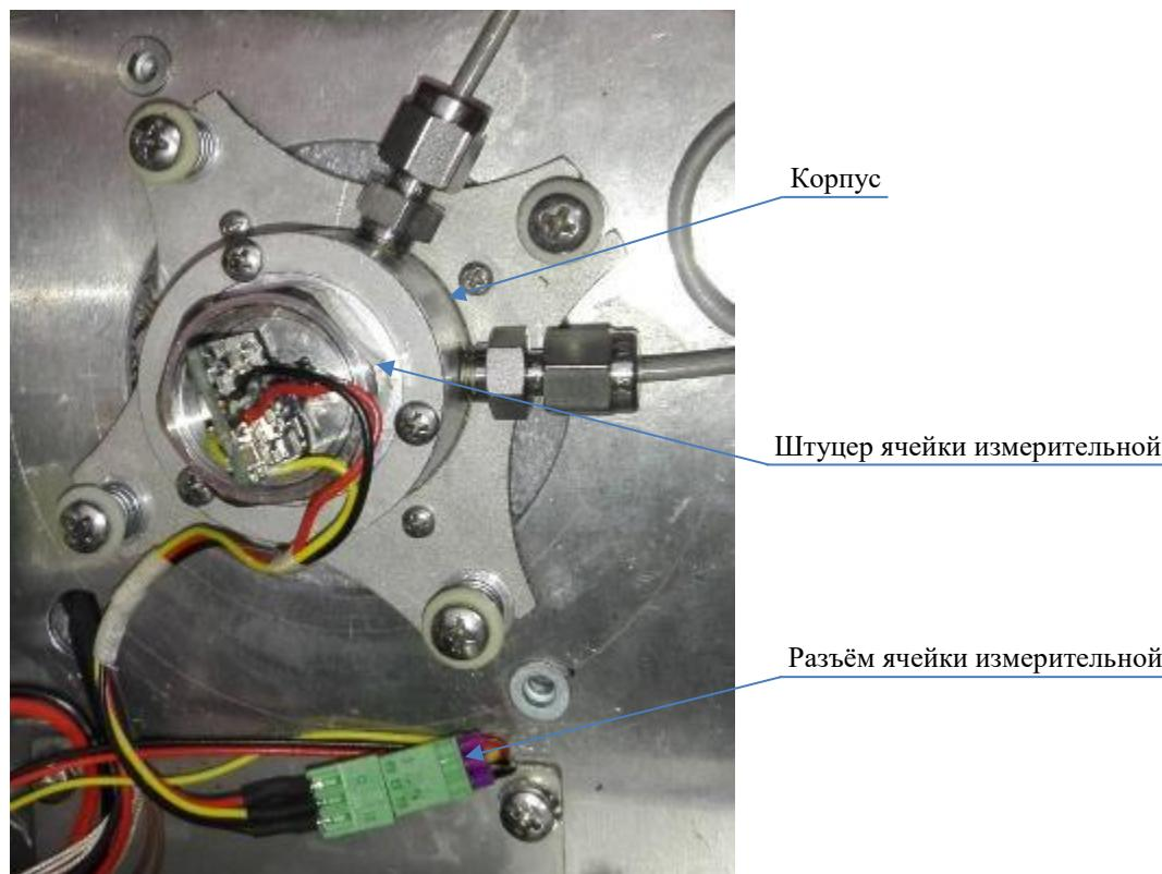
Рис. 26. Ячейка измерительная
