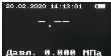
Данный режим длится примерно 15 секунд, до готовности прибора к проведению измерений.
