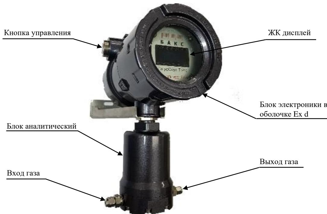
Рис. 6. Внешний вид анализатора «ГигроСкан-Т PRO»
