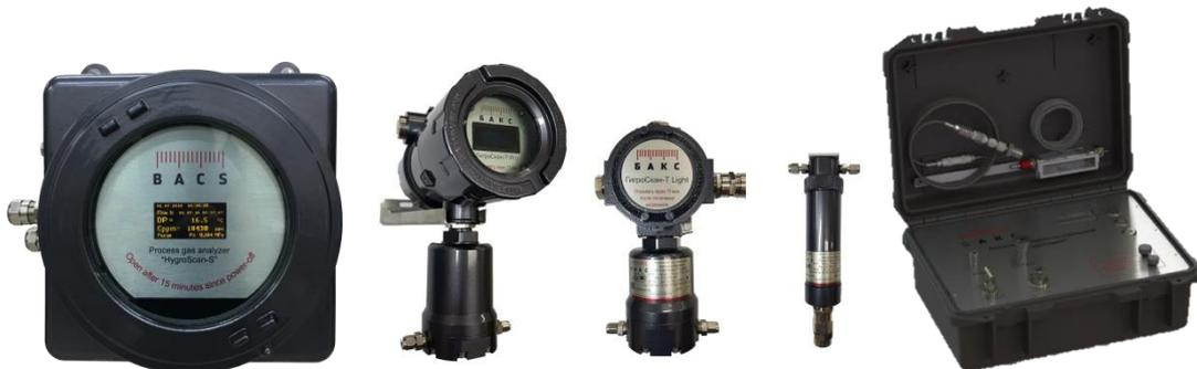
Анализаторы серии «ГигроСкан» предназначены для автоматического измерения массовой концентрации влаги и температуры точки росы (ТТРВ) по воде в газовых средах, в том числе в природном газе при рабочем давлении по ГОСТ 20060-83 и ГОСТ Р 53763-2009.
