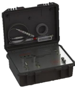
Анализатор предназначен для измерения концентрации влаги и точки росы по воде в различных газах в полевых условиях, в т.ч. при вводе в эксплуатацию газопроводов и после проведения ремонтных работ.
