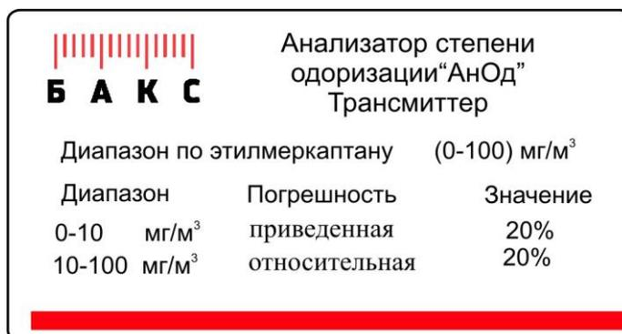
Рис. 6. Табличка с метрологическими характеристиками анализатора
