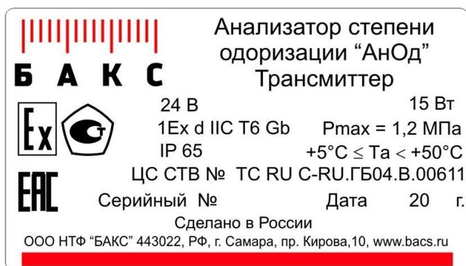
Рис. 5. Табличка, установленная на корпусе анализатора
