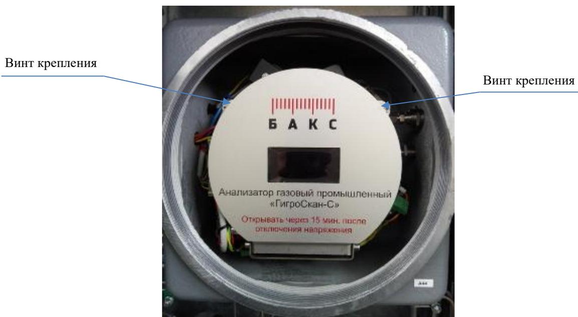
Рис. 24. Откидная панель с дисплеем
