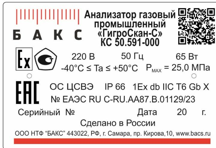
Рис. 11. Табличка, установленная на корпусе анализатора «ГигроСкан-С»
