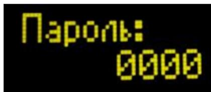
Рис. 23. Экраны с запросом на ввод пароля
