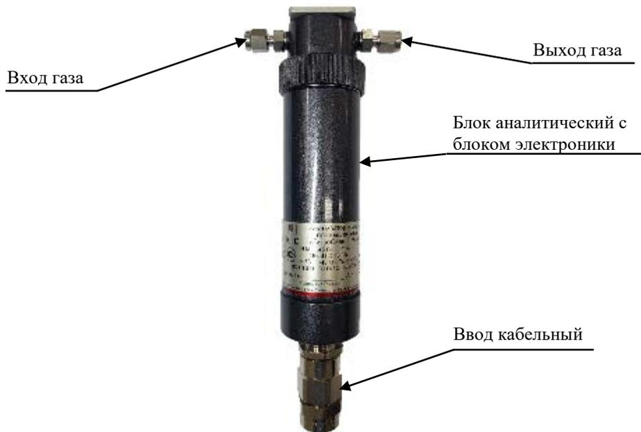
Рис. 8. Внешний вид анализатора «ГигроСкан-Т Микро»
