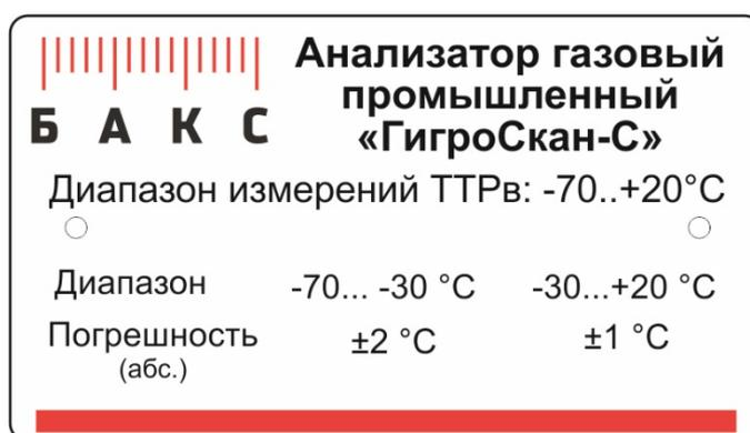
Рис. 15. Табличка с метрологическими характеристиками анализатора
