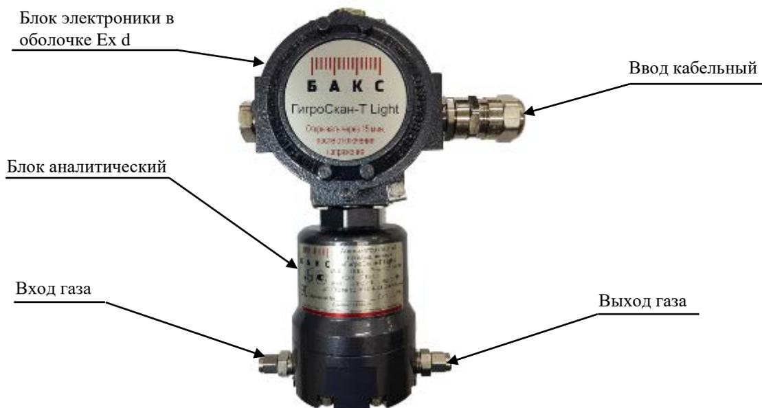
Рис. 7. Внешний вид анализатора «ГигроСкан-Т Light»
