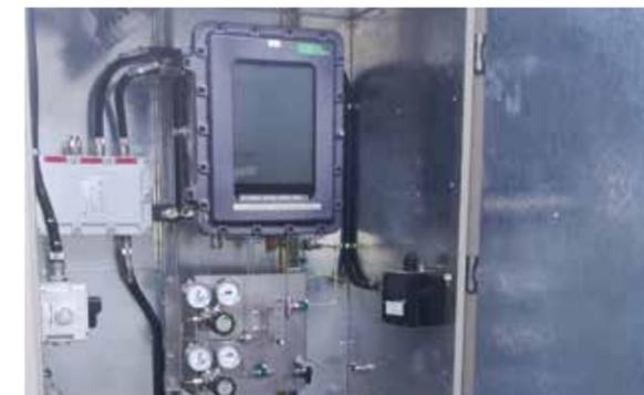
Потоковый газовый хроматограф МАГ для анализа синтез-газа и серосодержащих соединений в нём в блоке смешения с природным газом — 4 комплекса
