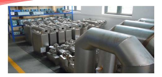
Расходомер МИР предназначен для прямого измерения массового расхода, плотности, температуры и вычисления объёмного расхода различных по составу жидкостей и газов.
