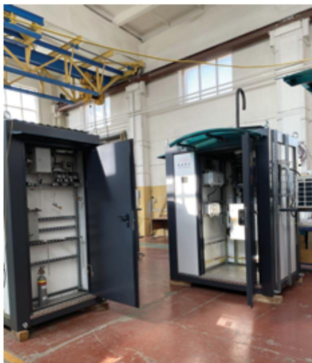
Установка производства МТБЭ / Поставка промышленных газовых хроматографов МАГ в блок-боксах для измерения состава углеводородных продуктов – 4 комплекса
