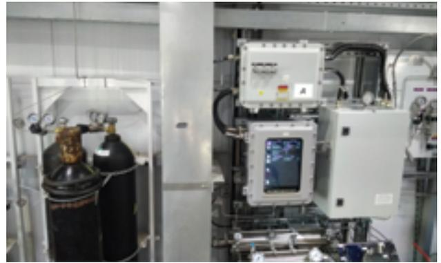
Измерительный комплекс на базе хроматографа «МАГ» для определения содержания метана и этана в нестабильном газовом конденсате
