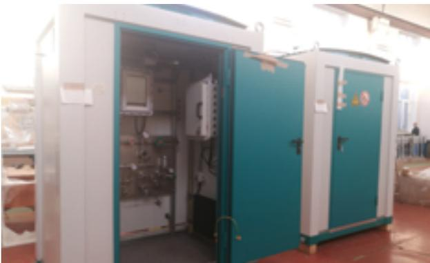
Аналитический комплекс для анализа контактного газа на установке дегидрирования бутана и оксигенатов в «сухом» пропане
