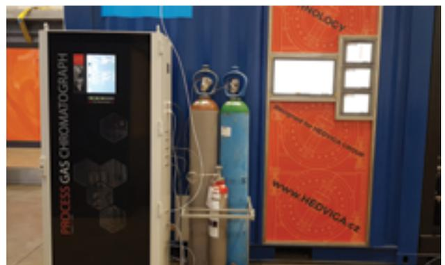
Измерительный комплекс на базе хроматографа МАГ для анализа компонентного состава газообразных продуктов пиролиза
