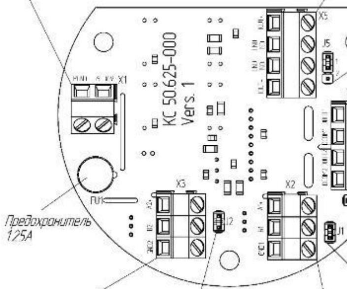
Джампер в состоянии "замкнуто" – терминальный резистор 120 Ом
