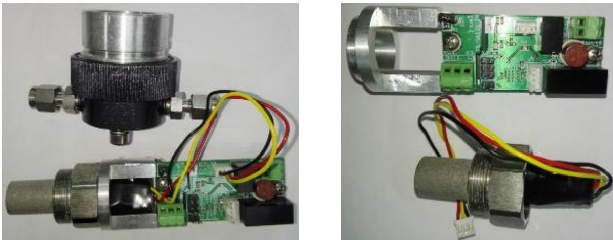
Рис. 29. Отсоединение измерительной ячейки от платы управления
