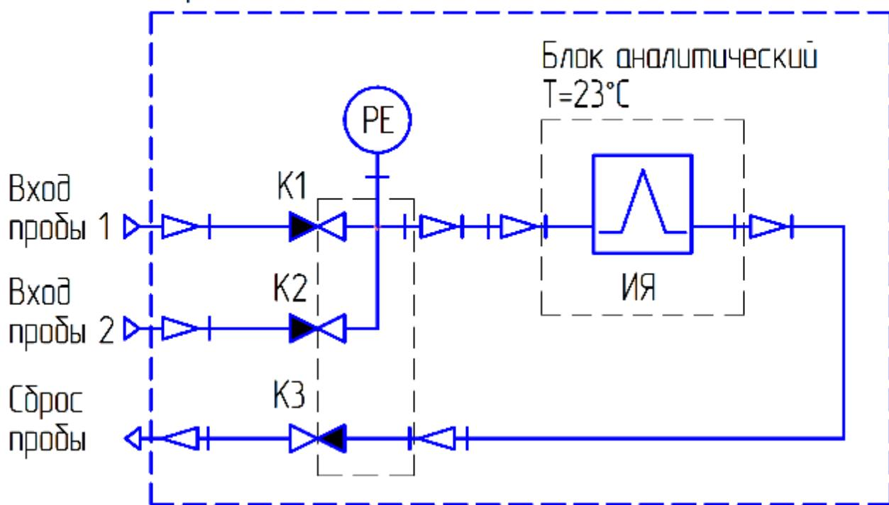
Рис. 5. Принципиальная газовая схема анализатора «ГигроСкан-С»
