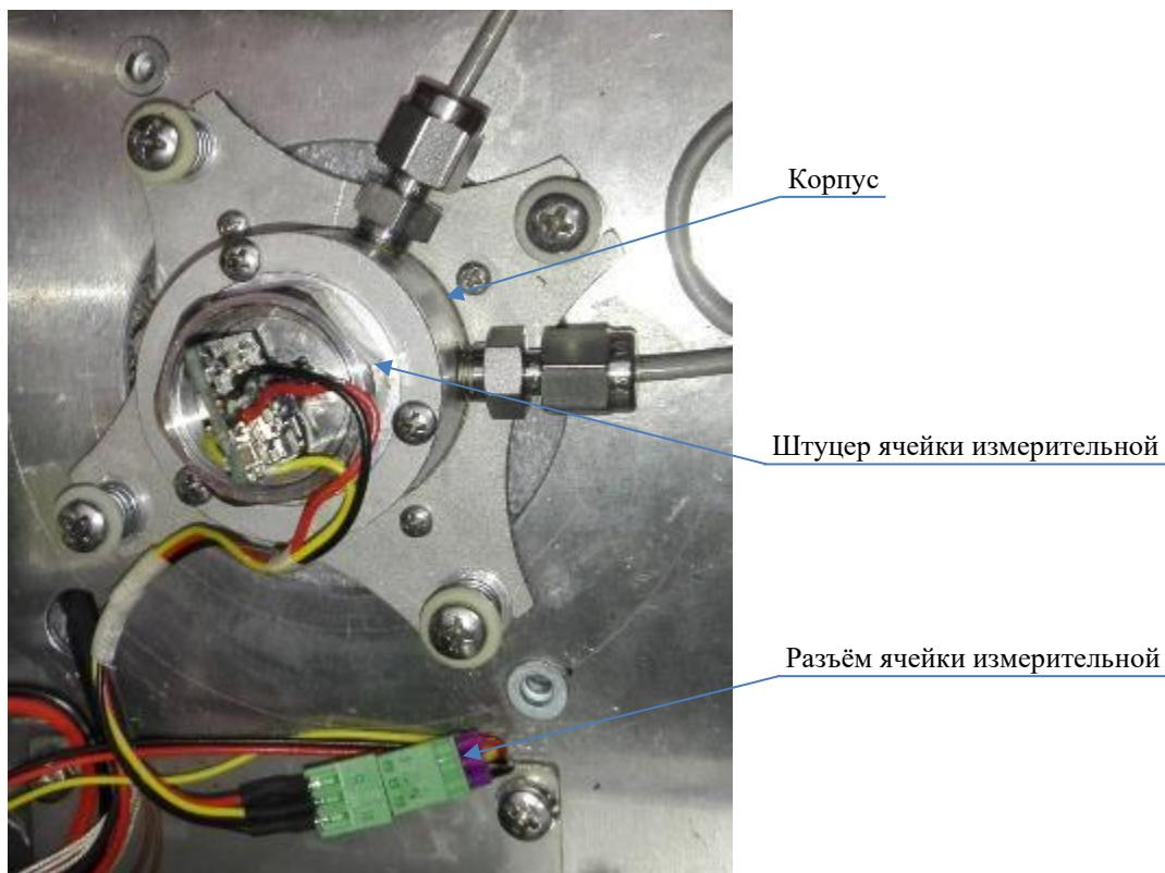
Рис. 26. Ячейка измерительная
