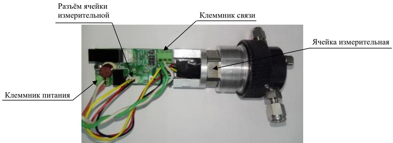
Рис. 28. Плата управления и ячейка измерительная
