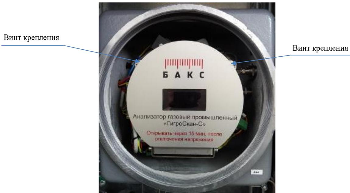
Рис. 24. Откидная панель с дисплеем
