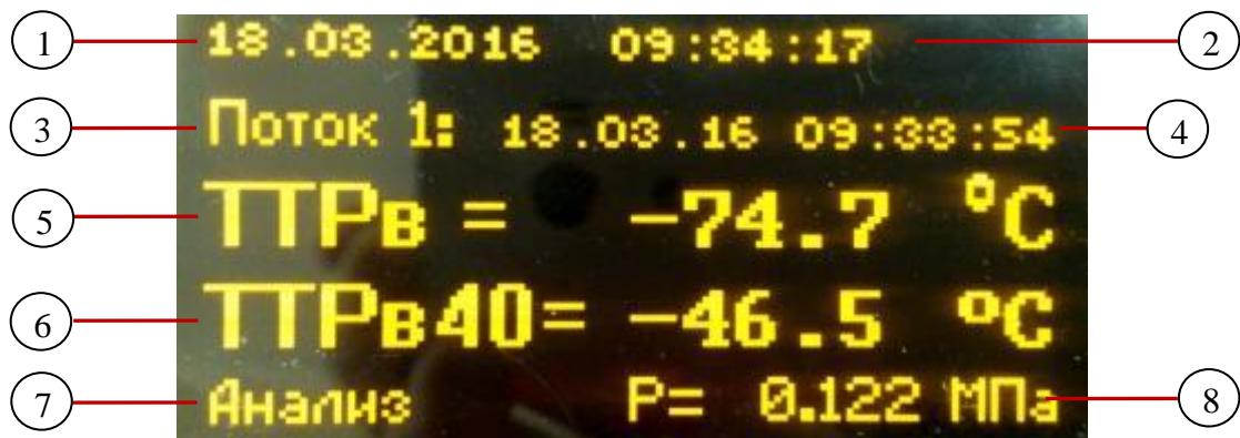
Рис. 17. Дисплей анализатора
