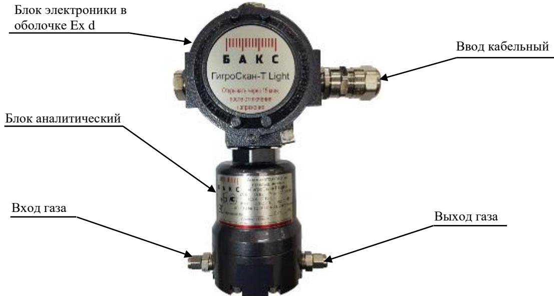
Рис. 7. Внешний вид анализатора «ГигроСкан-T Light»
