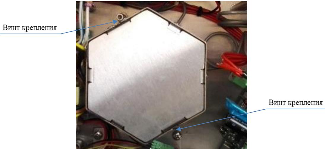
Рис. 25. Кожух термостата
