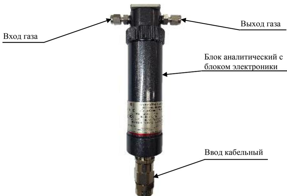
Рис. 9. Внешний вид анализатора «ГигроСкан-Т Micro»
