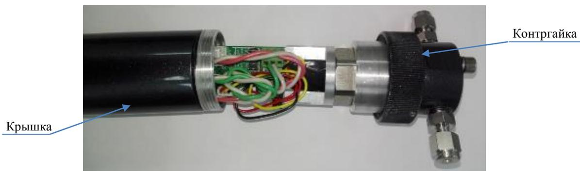
Рис. 28. Корпус анализатора ГигроСкан-Т Micro.
