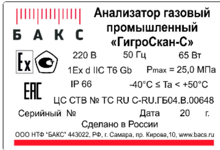
Рис. 12. Табличка, установленная на корпусе анализатора «ГигроСкан-С»
