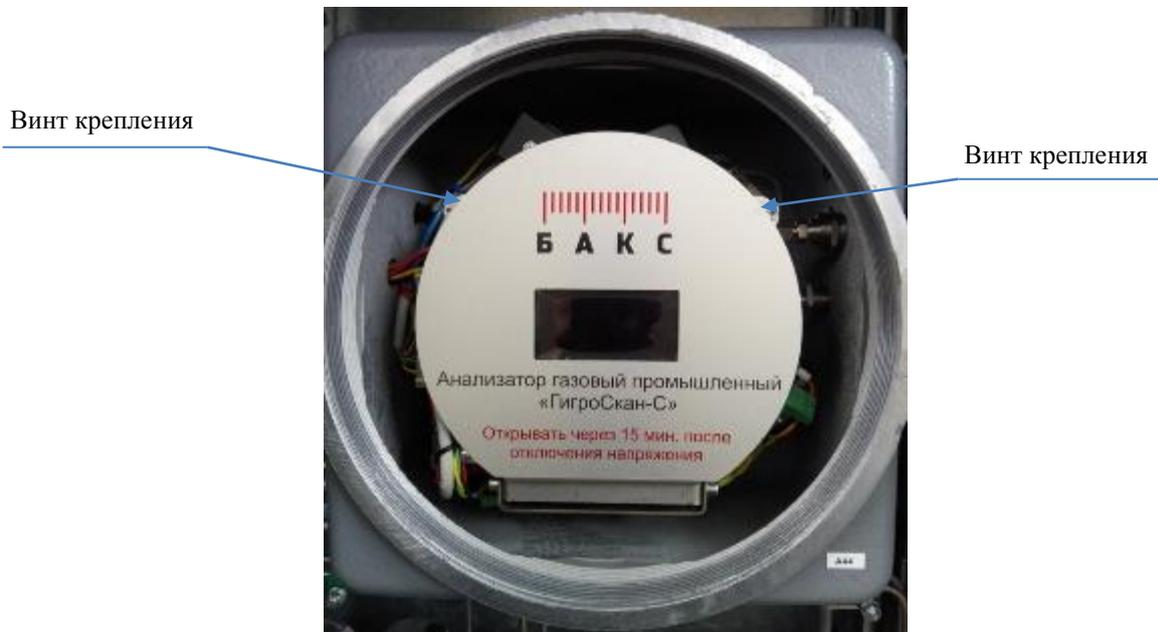
Рис. 25. Откидная панель с дисплеем
