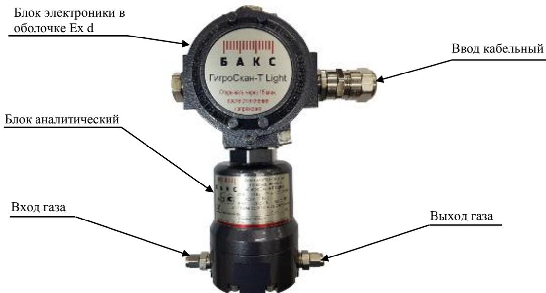
Рис. 8. Внешний вид анализатора «ГигроСкан-Т Light»
