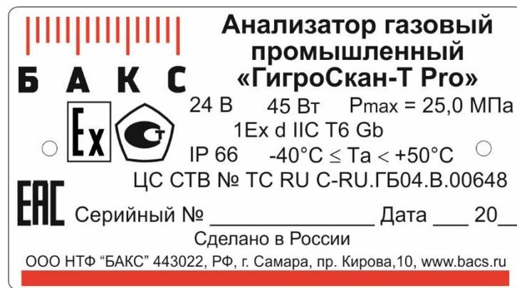
Рис. 13. Табличка, установленная на корпусе анализатора «ГигроСкан-Т PRO»
