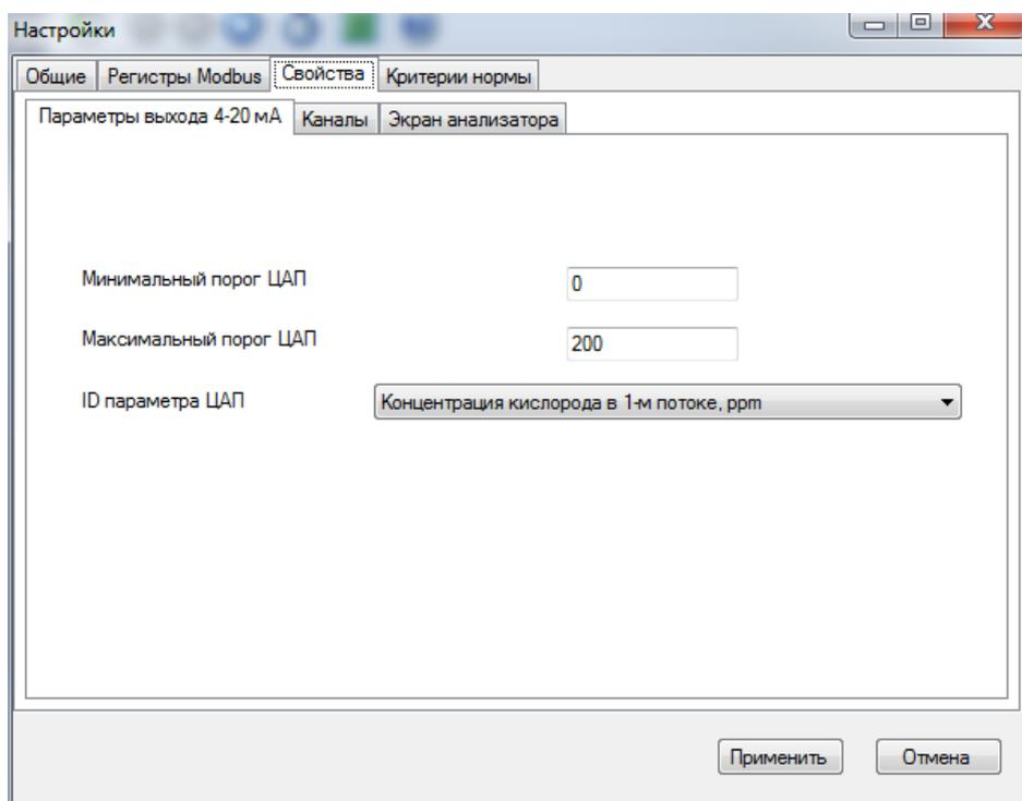
Рис. 13: Вкладка «Параметры выхода 4-20 мА»
