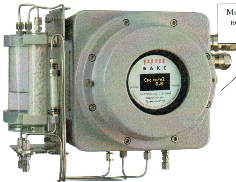
Рисунок 3 – Анализаторы газовые промышленные модели «АнОд» транзиттер КС 50.250-000-01, общий вид
