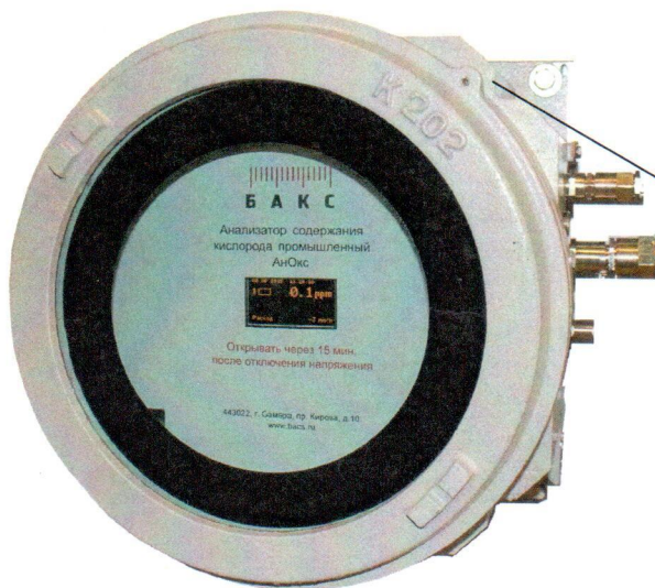
Рисунок 1 – Анализаторы газовые промышленные модели «АнОкс» КС 50.260-000, «АнОд» КС 50.250-000 (исполнение 1), общий вид
