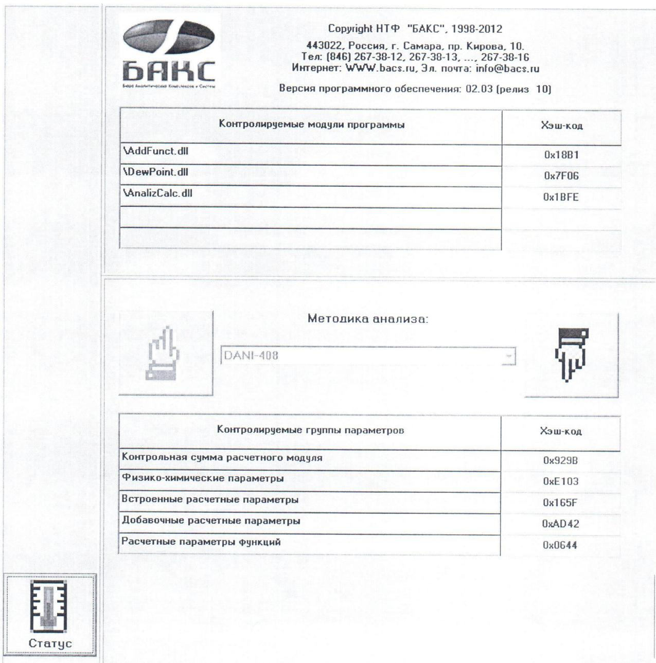
Считают, что хроматограф выдержал поверку по п.6.3, если в нижней таблице приведенный перечень CRC-кодов контролируемых блоков настроек для выбранной методики анализы (аналитической задачи) соответствует номерам (цифрам), указанным в разделе «Программное обеспечение» описания типа.
