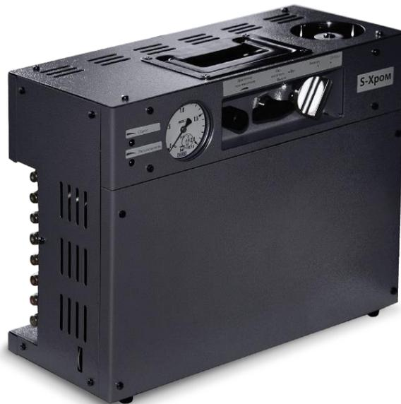
«S-Хром» – портативный газовый хроматограф с электрохимическим детектором (ЭХД) для анализа сероводорода и меркаптанов в различных средах, включая газ горючий природный по ГОСТ Р 53637-2009
